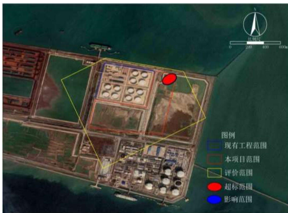
图6.3-2 1000d 时地下水中石油类迁移距离示意图
