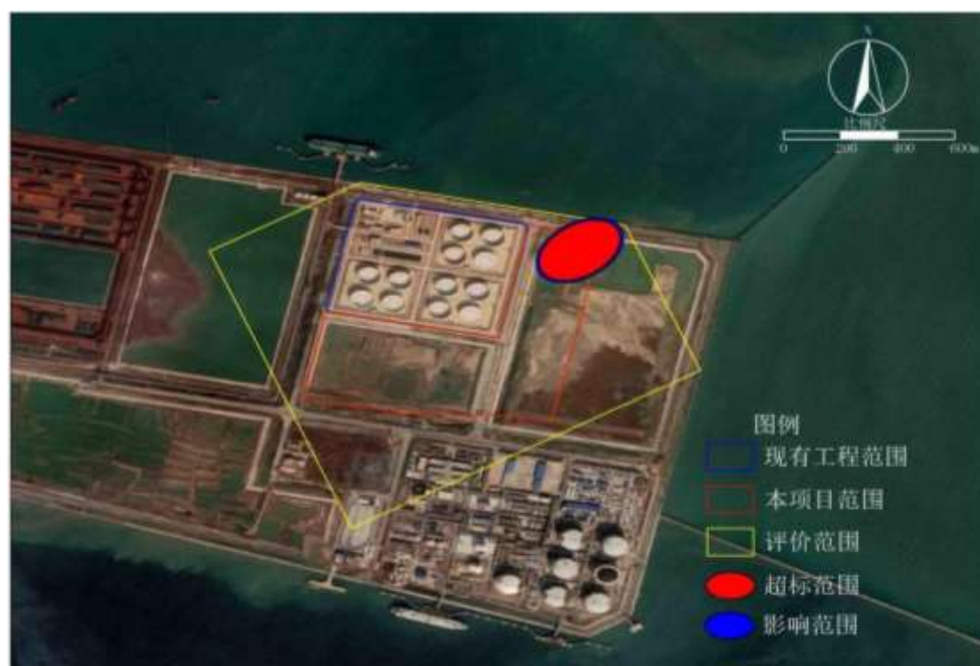
图6.3-3 3650d 时地下水中石油类迁移距离示意图
