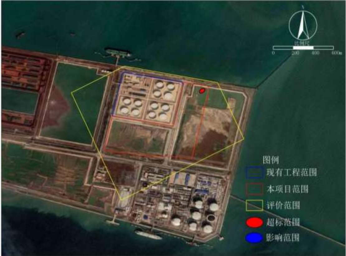
图6.3-1 100d 时地下水中石油类迁移距离示意图
