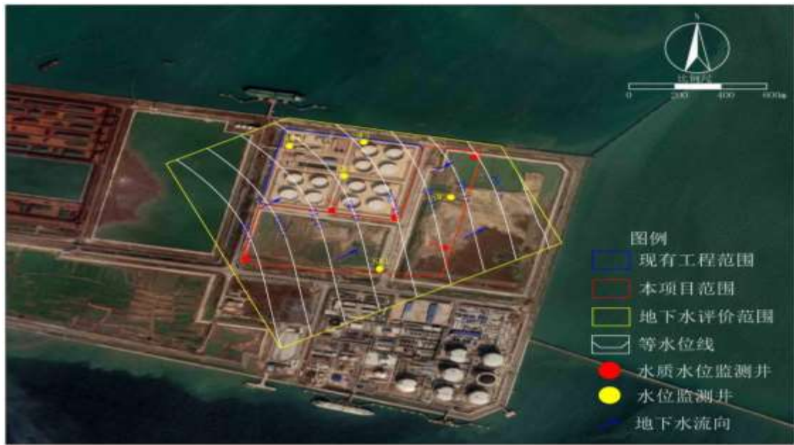
图4.3-9 项目评价区潜水含水层水位等值线图
