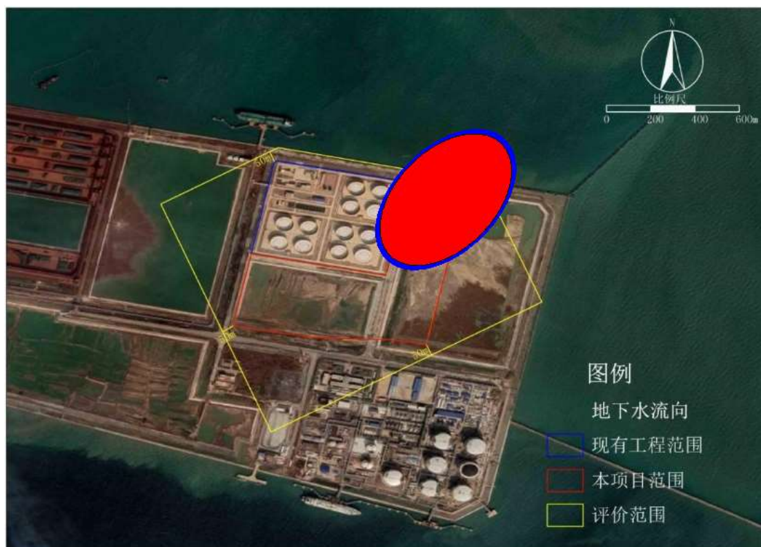
图6.3-4 18250d 时地下水中石油类迁移距离示意图
