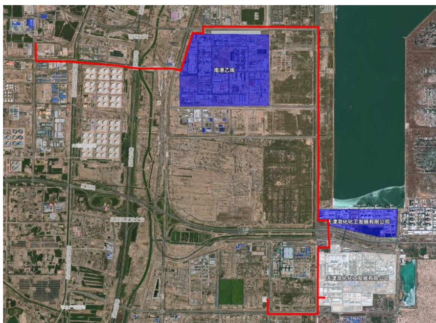
图 4.2-12 南港工业区内管廊氧气管线走向
