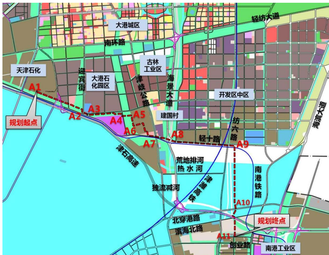
图 4.2-8 氧气管线沿石化管廊路由走向
